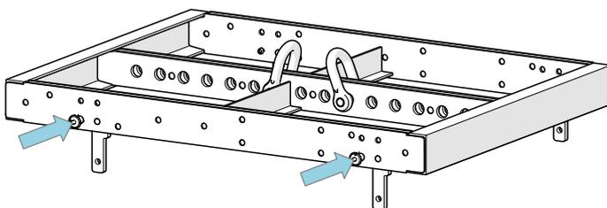
**03** Conecte a lingueta no grid frontal e traseiro e trave com os quick pins
