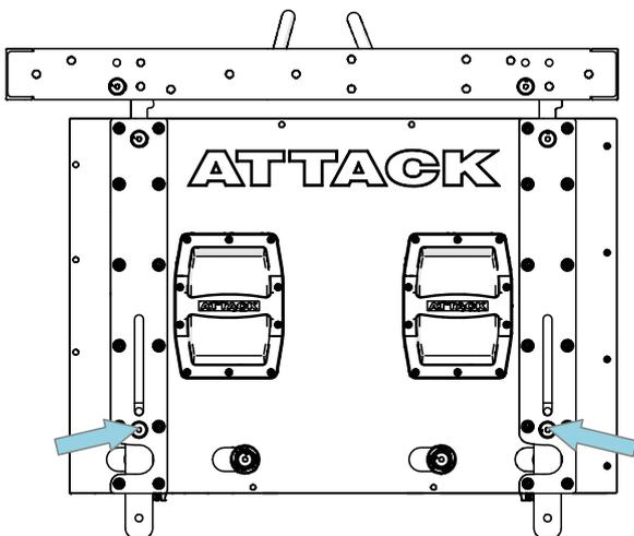
**03** Utilize os quick pins acoplados na caixa para fixação entre grids
