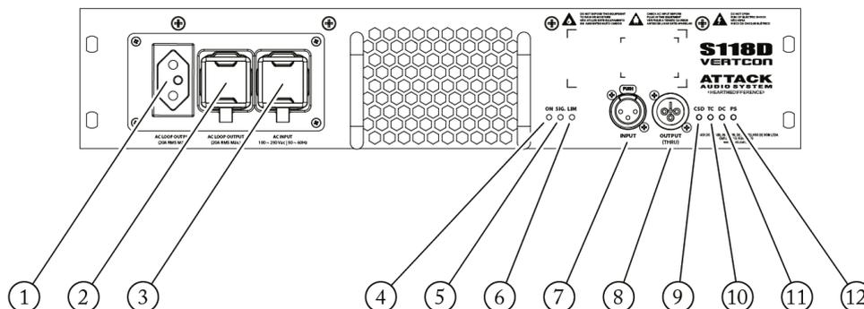
1 – AC LOOP OUTPUT NBR- Conector para conexão paralela de AC, 2P+T, no padrão NBR 14.136. Não utilizar mais do que quatro caixas, ligadas em paralelo.
