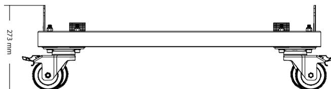
**01** Retire os quick pins e posicione o L208D sobre o suporte móvel EMV L208D se orientando pelos furos conforme a ilustração
